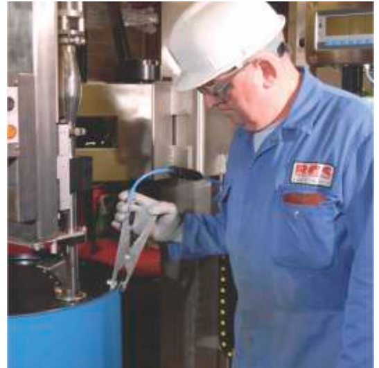
Comprend une pince universelle de mise à la terre avec raccord rapide et différentes longueurs de câbles 2 conducteurs protégés Hytrel.
