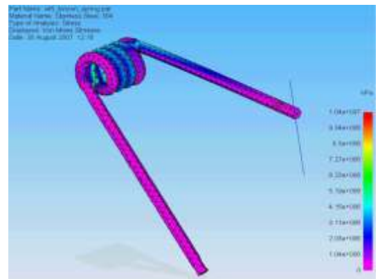
Les ressorts Newson Gale sont conçus et analysés à l'aide des technologies de Finite Element Analysis.
