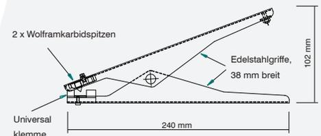
zweipolige Erdungsklammern und zwei Wolframkarbidspitzen
