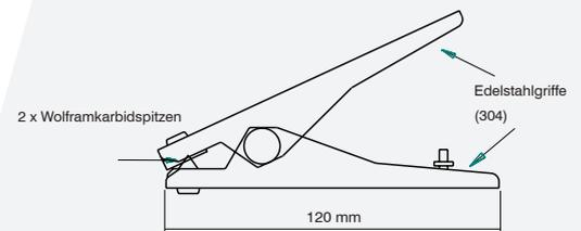
zweipolige Erdungsklammern und zwei Wolframkarbidspitzen
